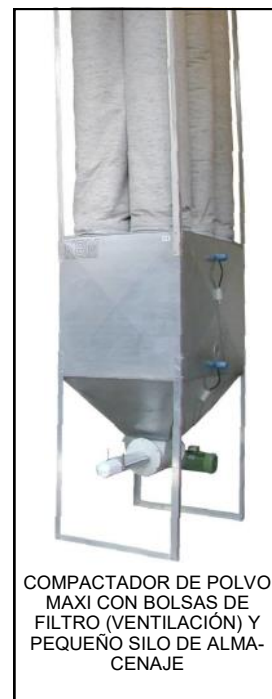
DUST-FLEX MAXI/JUMBO - COMPACTADOR DE POLVO FLEXIBLE CON UN SILO PEQUEÑO PARA SER LLENADO MANUALMENTE. SIN TRANSPORTE DE AIRE. DISPONIBLE CON RUEDAS O SOPORTES
