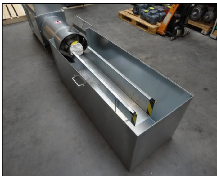
Styropactor MINI 3-fases con una bañera para la bandeja de salida.
