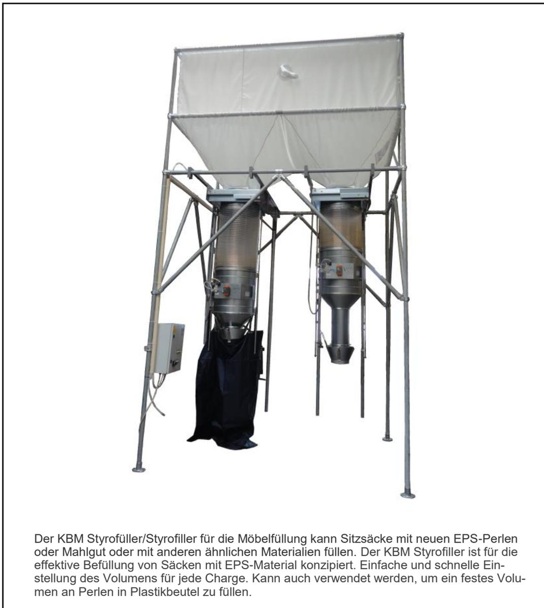
Der KBM Styrofüller/Styrofiller für die Möbelfüllung kann Sitzsäcke mit neuen EPS-Perlen oder Mahlgut oder mit anderen ähnlichen Materialien füllen. Der KBM Styrofiller ist für die effektive Befüllung von Säcken mit EPS-Material konzipiert. Einfache und schnelle Einstellung des Volumens für jede Charge. Kann auch verwendet werden, um ein festes Volumen an Perlen in Plastikbeutel zu füllen.
