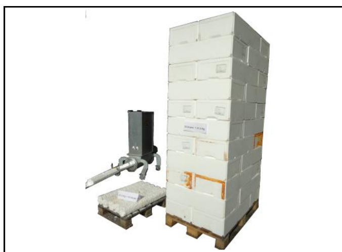
Styropactor NANO eller "Styropor billen" illustrerer 33 kompakterede og 33 ikke-kompakterede fiskekasser.
