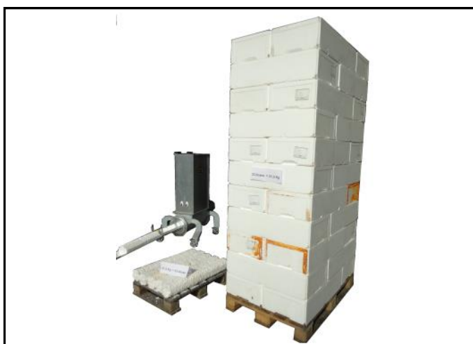
O Styropactor NANO "Besouro de Isopor" com 33 caixas de peixe. 33 não compactadas e 33 compactadas.
