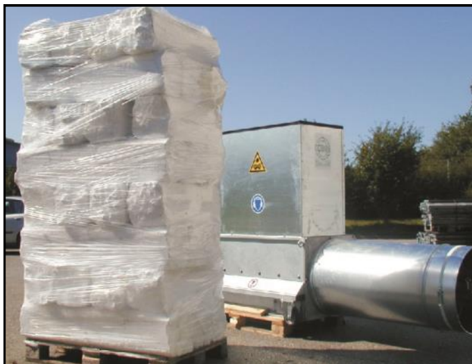
Styropactor MAXI: Partes comprimidas empilhadas em uma pálete para a manipulação fácil.
