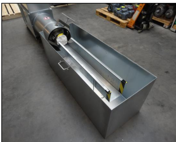
Styropactor MINI 3-fases com uma cuba anexada para a bandeja de saída.
