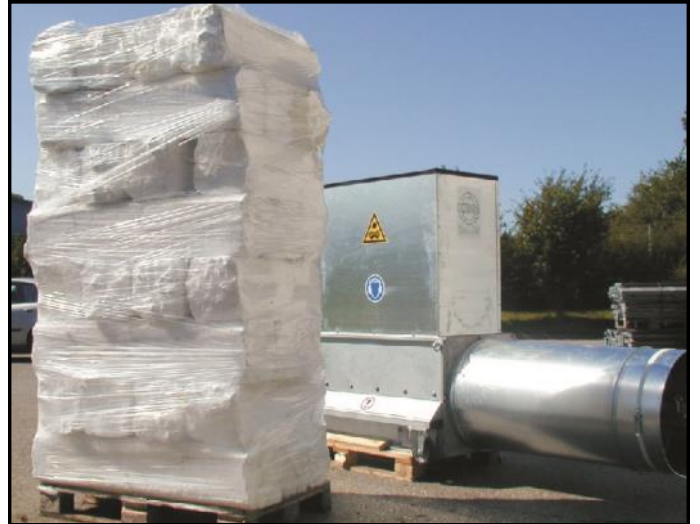
Styropactor MAXI: Kompaktierte Stücke gestapelt auf einer Palette für einfache Handtierung.
