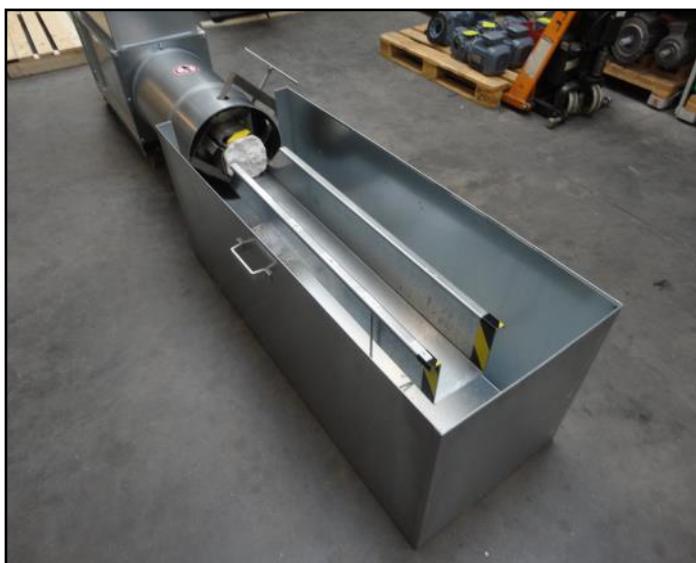
Styropactor MINI 3-fasi con una vasca collegata per il vassoio di uscita.
