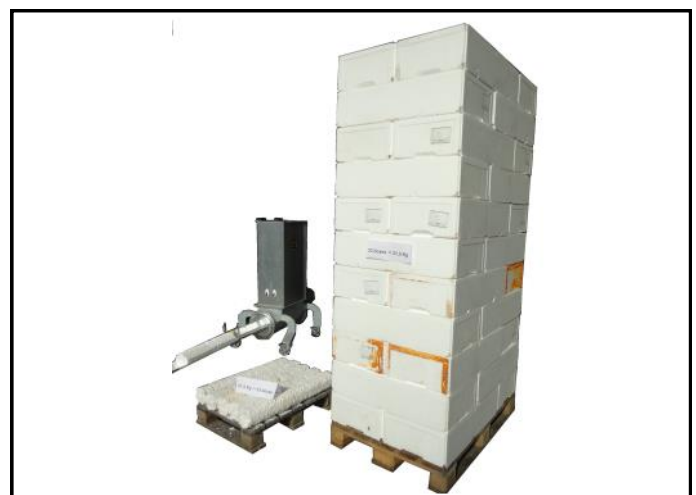
Il NANO Styropactor "Scarabeo Polistirolo" con 33 scatole di pesce. 33 non compattate e 33 compattate.
