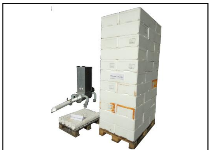
El Styropactor NANO "Escarabajo EPS" con 33 cajas de pescado. 33 no compactado y 33 compactado.
