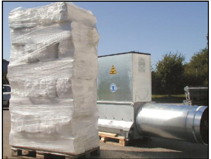
Styropactor MAXI: Piezas comprimidas apiladas en una paleta para manejo fácil.
