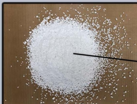
Nach dem Vorzerkleinern, Filtern, Granulieren und Entstauben schwerer Teile. Fertig zum Mischen mit neuem EPS
