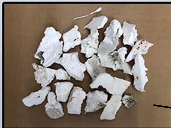
Mit dem SCHWERTEILABSCHIEDER in Verbindung mit einem KBM-Recyclingsystem beträgt die erhaltene Reinheit des EPS-Abfalls fast 99% und kann als solcher ähnlich wie EPS Schnittschrott von Blockschnidlinien wiederverwendet werden.
