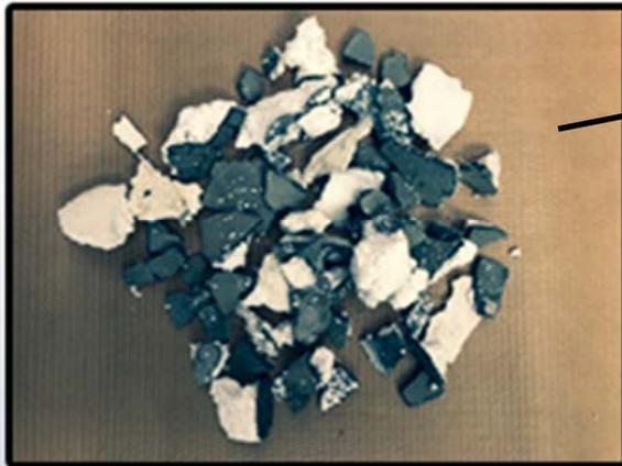
Gesammelter Betonabfall nach dem Vorzerkleinern in einem KBM-Vorbrecher. Das Material wird am Boden des Vorbrechers gesammelt
