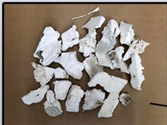
Avec le séparateur de pièces lourdes et un système de recyclage KBM, la pureté obtenue des déchets de PSE est proche de 99%, et par conséquent le matériau peut être réutilisé dans votre production avec les morceaux restants de la ligne de coupe.
