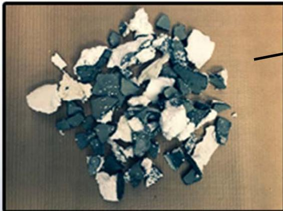
Des déchets de béton séparés après le pré-broyage sur un pré-broyeur KBM. Le matériau est recueilli dans la base du pré-broyeur.
