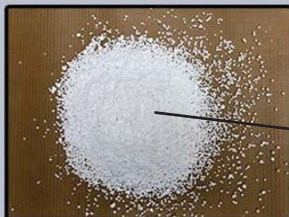
Después de la pre-trituración, separación de piezas pesadas, granulación y desempolvado. Granulado listo para ser mezclado con material vírgen de EPS
