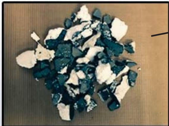
Residuos de hormigón recogidos después de la pre-trituración en una pre-trituradora KBM. El material es recogido en el fondo de la pre-trituradora.
