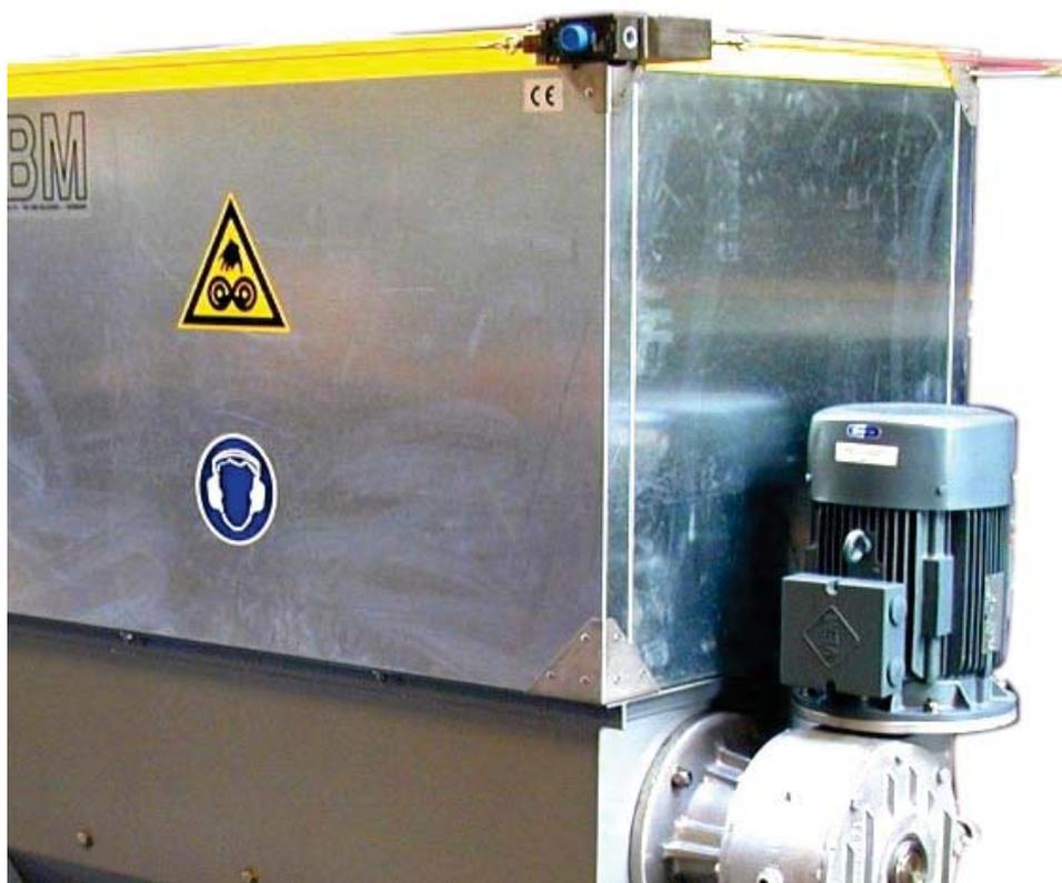
Las pre-trituradoras MAXI y JUMBO están diseñados para separar y recoger piezas metálicas, piedras y otras piezas pesadas que pueden haber llegado a la tolva. Estas piezas pesadas se recogen en el fondo de la máquina y se pueden extraer por una apertura de fácil acceso.
