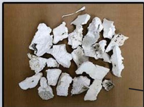
Residuos de EPS recogidos y separados en el SEPARADOR DE PIEZAS PESADAS. Los residuos se recogen fácilmente en el fondo del separador
